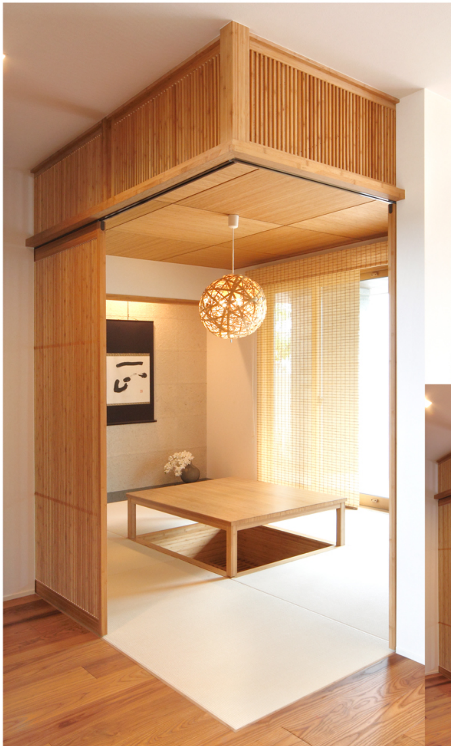
欄間竹格子・引戸竹格子・竹掘座卓・床の間竹紙貼・天井竹板貼・真竹やたら編み照明
