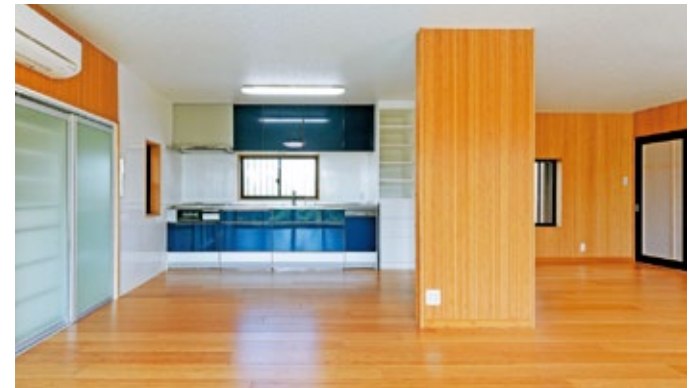
【離れ】 台所 壁 竹板仕上げ 自然塗装仕上げ 床 竹フローリング
